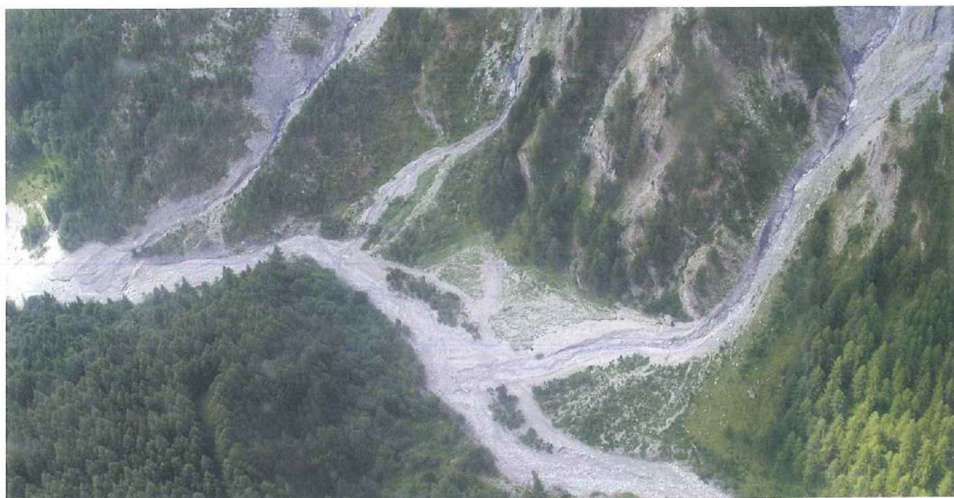
FIG. 7 - Nel bacino della Dora di Bardonecchia, nel primo pomeriggio del 25 luglio 2006 si sono riversate precipitazioni temporalesche intense che, lungo l'asta del T. Rho, hanno prodotto una colata di fango e detriti ( muddy debris flow ) che si è propagata sino al sottostante abitato di Bardonecchia.
