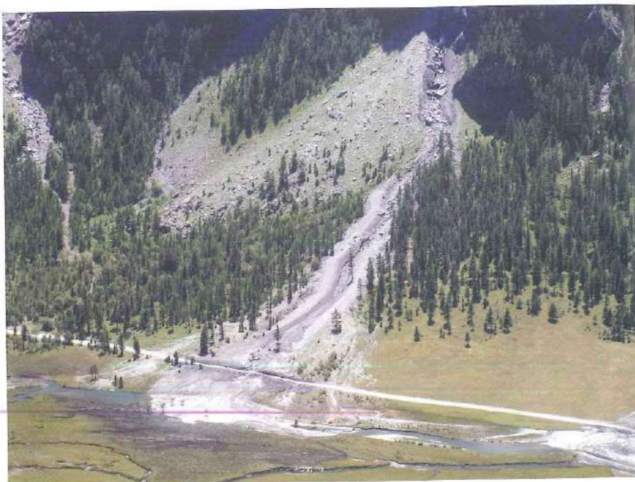
FIG. 3 - Il 6 luglio 2006, a seguito di una precipitazione con intensità efficace pari a 9,2 mm in 10 minuti (Stazione "Sauze di Cesana"; ARPA Piemonte), si sono prodotte alcune colate detritiche lungo il versante sinistro del T. Ripa (Comune di Cesana Torinese) che si sono riversate sui rispettivi conoidi con interruzione della viabilità ed invasione dell'asta principale.
